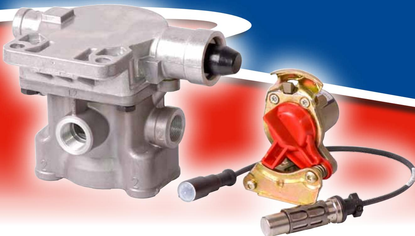
*Les systèmes de freinage pneumatique pour remorque doivent se caractériser par une sécurité et une fiabilité à toute épreuve. Il est donc essentiel d'effectuer un entretien régulier et de disposer de pièces de haute qualité pour assurer le bon fonctionnement du système de freinage. TRP propose désormais une gamme complète, homologuée TÜV, de pièces de freins pneumatiques pour remorque constituant une alternative à Wabco, Knorr et Haldex. Une solution sûre et fiable !*
