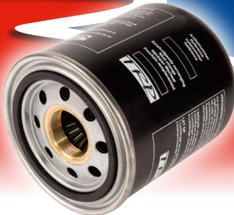
*TRP offre une gamme complète de cartouches dessiccateur afin de protéger le système de freinage pneumatique contre la pollution et les dommages causés par l'humidité et les résidus d'huile. Le filtre à huile intégré retient les gouttelettes d'huile contenues dans l'air d'admission avant que l'air ne soit séché, garantissant ainsi des performances de séchage exceptionnelles à tout moment.*
